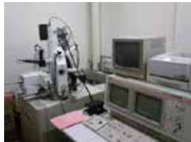
弘前大学理工学部のEPMA JEOL-JXA8800 RL (波長分散型4チャンネル) 写真提供：松正純氏
